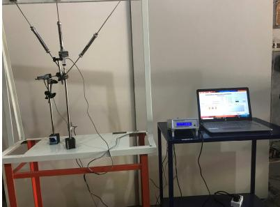
REDUNDANT JOINT APPARATUS (DIGITAL)
